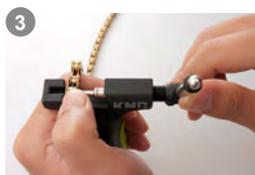
3 用拇指緊壓鏈條上緣，轉動螺桿讓頂軸頂住欲打出的鏈軸。
