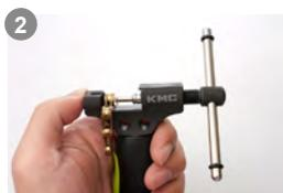
2 將鏈條放在固定基座，將要打出的鏈軸對準螺桿頂軸。
