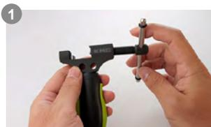
1 轉動壓軸螺桿直到整支退出。
