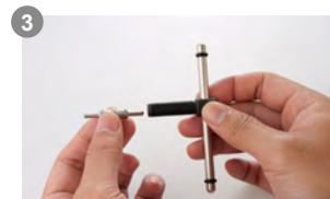
3 拉出頂軸並換邊裝回頂軸,再將螺桿裝回打鏈器本體。
