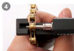
4 確認頂軸準確頂在鏈軸上後，繼續施力轉動螺桿直到打出鏈軸。
