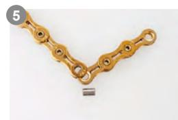
5 確認打出鏈軸後轉動退開螺桿，將鏈條取出即完成打鏈。
