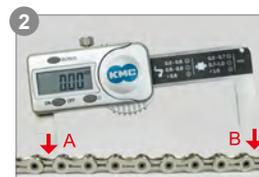
先將A端卡入鏈條間隙，再將B端壓入鏈條間隙。
