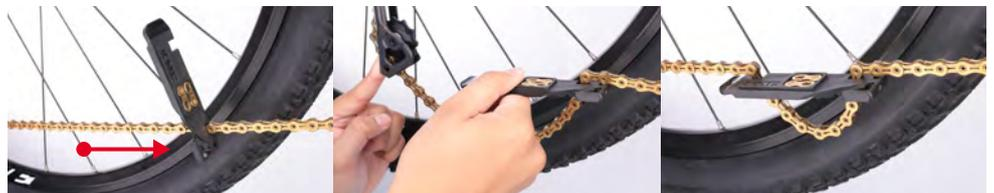
**勾鏈棒：**以拆鏈位置為基準點，於1個棒身距離的位置處，將棒身與鏈條呈90度，勾住鏈條一端後，手壓後變速器彈腿放鬆鏈條，再勾住鏈條另一端
