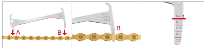
圖1：先將A端卡入鏈條，再將B放入鏈條間隙
